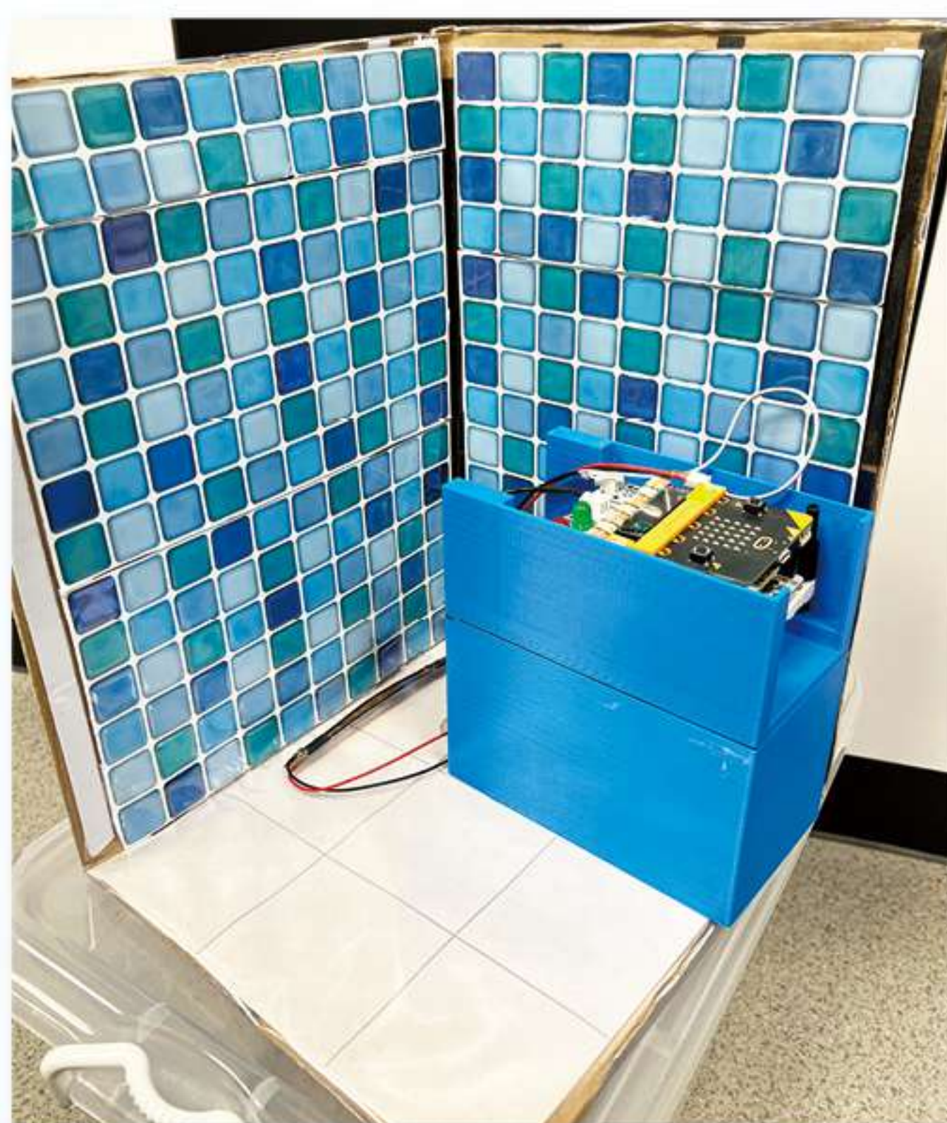
智能 U 型管水位探測器
