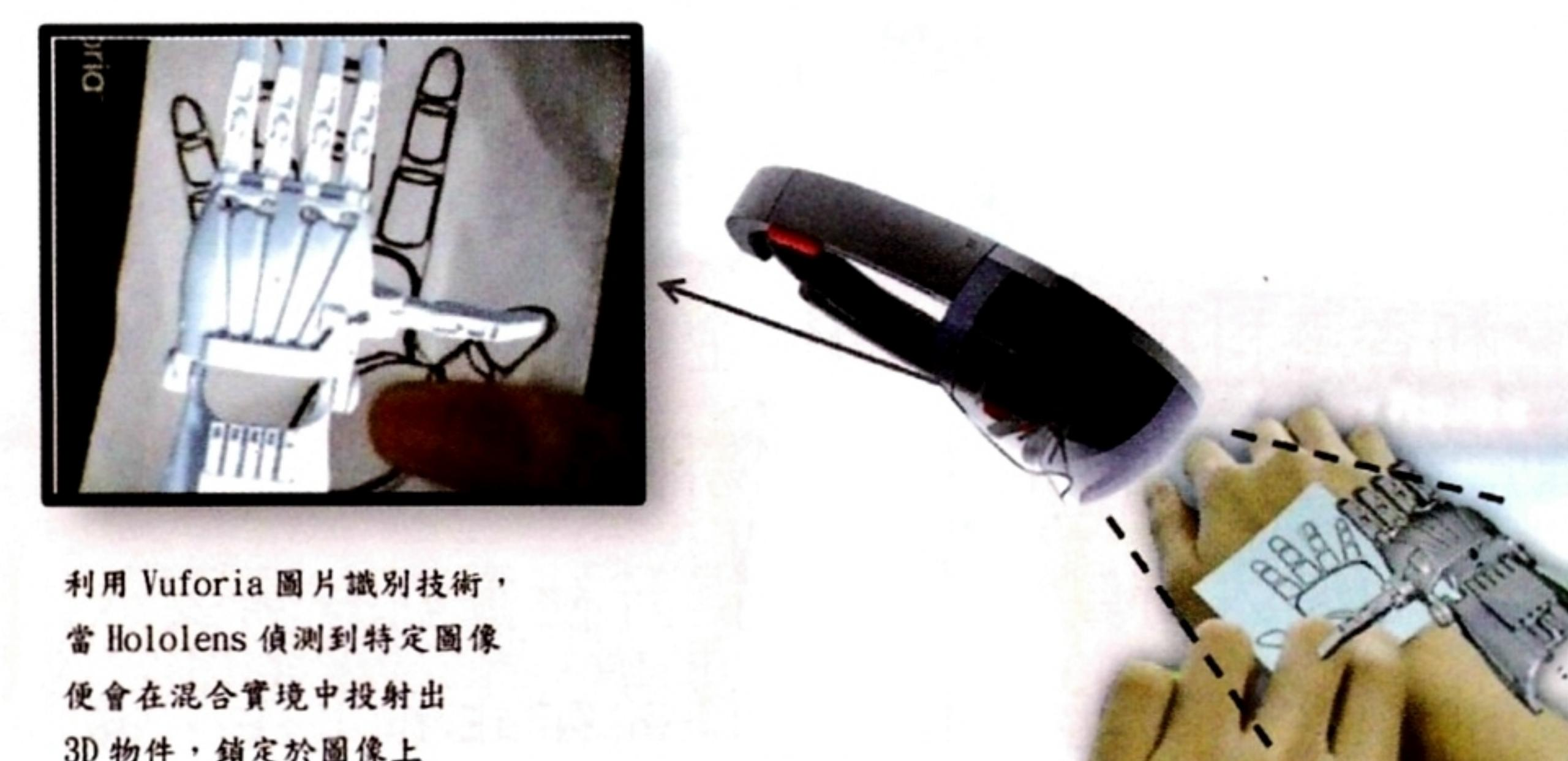
利用 Vuforia 圖片識別技術，當 HoloLens 偵測到特定圖像便會在混合實境中投射出 3D 物件，鎖定於圖像上
